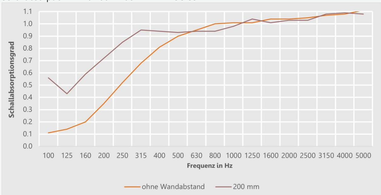
Schallabsorption im Hallraum nach DIN EN ISO 354
